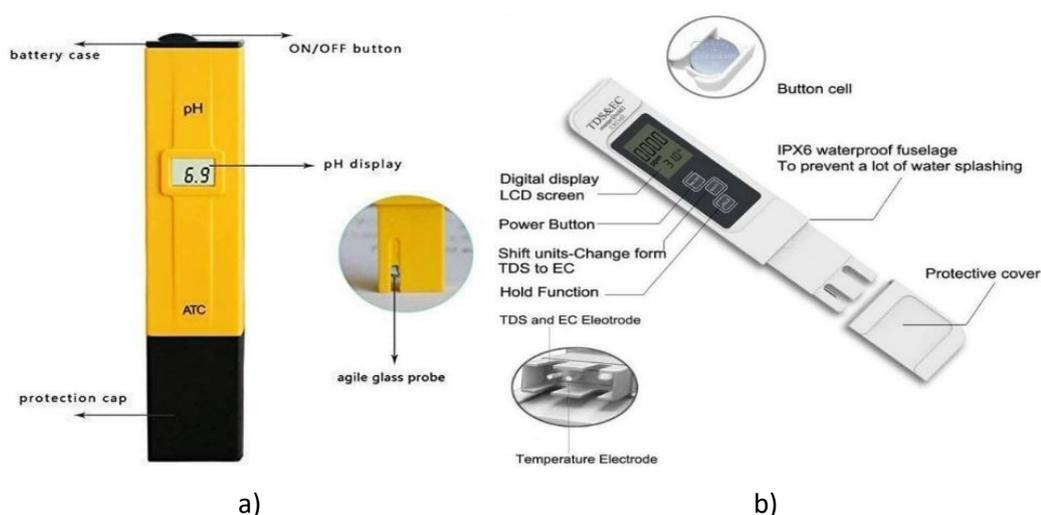
**Figure 2.13:** (a) pH meter (b) TDS/EC meter
